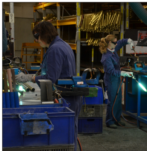
Leitungen: Frauen schweißen Messingrohre.
