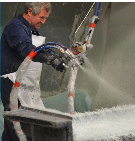
Kunststoffteile: Aufbringen der Fasern.
