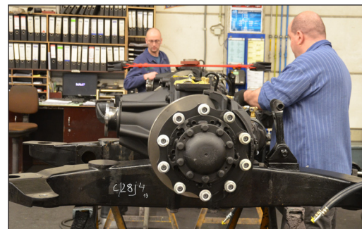
Achsmontage: Vorbereitung für den Einbau.
